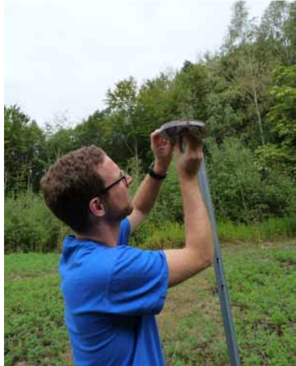
Passivsammlersystem zum Messen von Ammoniak- und Stickstoffdioxidkonzentrationen an der saarländischen Station Fischbach
