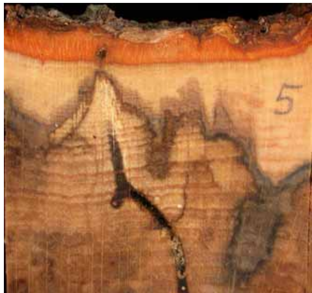
Abb. 9: Schwarte 5; Holz fleckig, mit großflächigem Einlauf und Verstockung Fig. 9: Slab 5; wood discolored from oxidation and from white rot fungi
