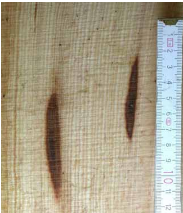
Abb. 4: Schwarte 200: axiale Ausdehnung der Verfärbungen um die Bohrlöcher
