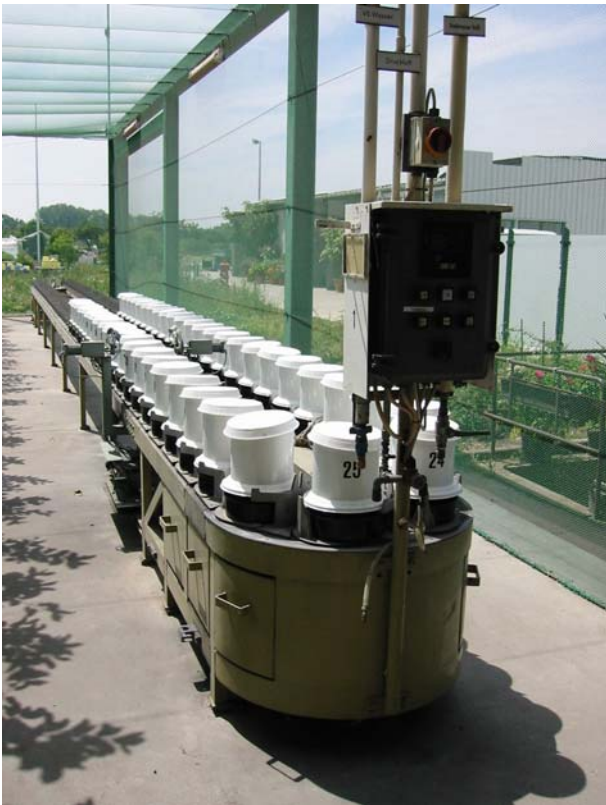
Abb. 1.3: Gefäßversuch in Limburgerhof und Aufbau der Mitscherlichgefäße.
