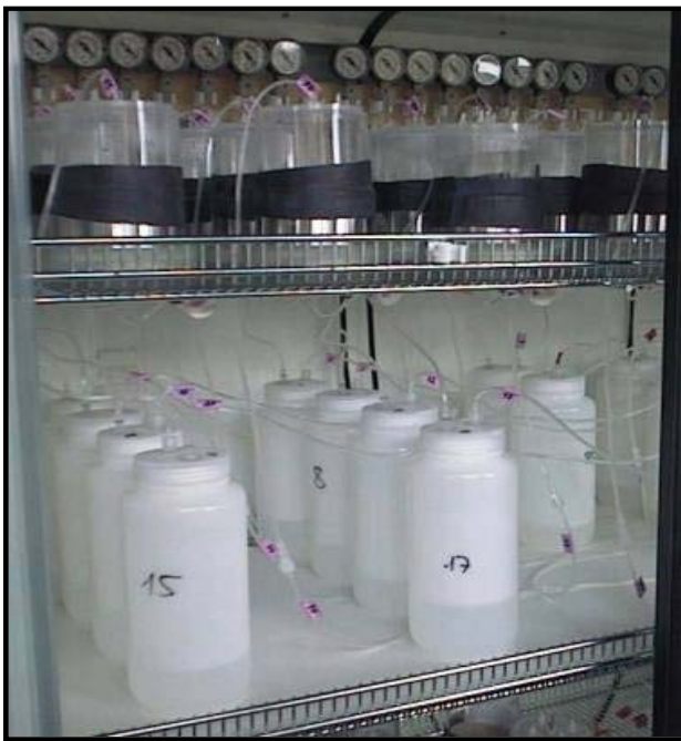
Abb. 1.7: Aufbau und Profilschaltung der Perkulationsapparatur
