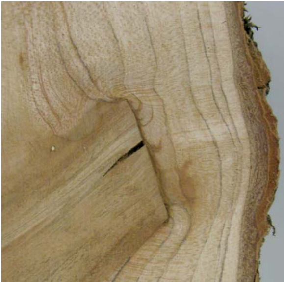
Abb 7c: Überwallter Grünast von 2,6 cm Aststärke (Parz. 4). Im Überwallungsgewebe hat sich ein schmaler Kanal von eingewachsener Rinde gebildet
