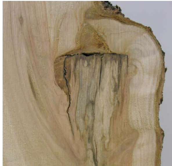
Abb. 7d: Starker, verkernter Trockenast von 4,2 cm Aststärke (Parz. 4). Durch ihn drang die Fäule durch den Splint in das Kernholz
