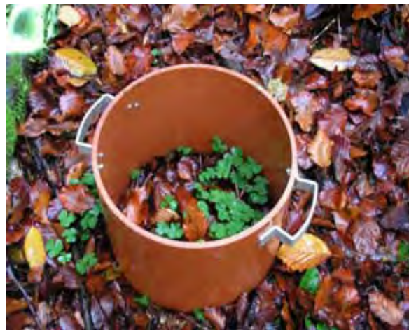
Foto 3: Kunststoffzylinder zur Beprobung von Humusaufgaben ohne Oh-Lage
