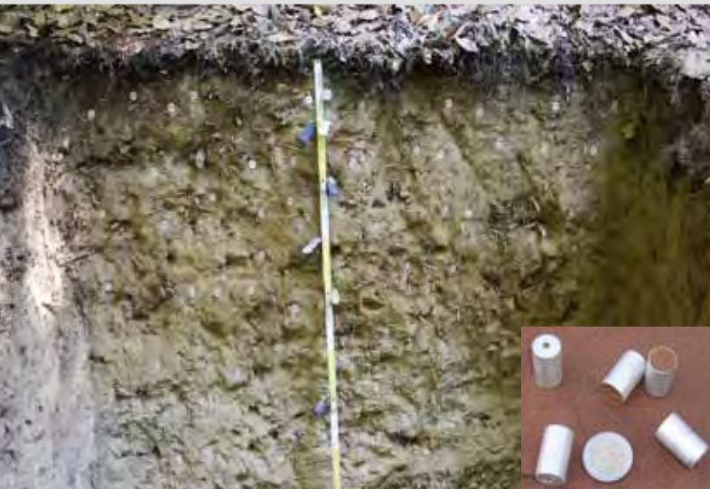
Foto 5: Einsatz von Alu-Steckkappen zur Ermittlung der Trockenrohddichte
