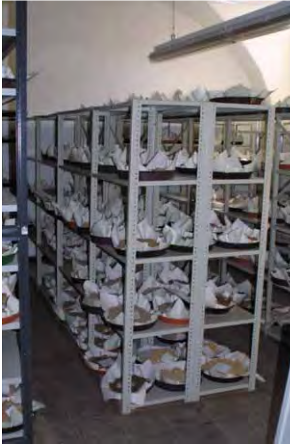
Foto 8: Lufttrocknung der Bodenproben
