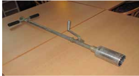
Foto 2: „Murach'scher“ Bohrer zur Humus- und Mineralbodenbeprobung an den Satellitenpunkten
